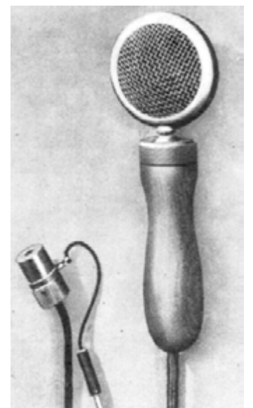
Die einfachste Form des Kristallmikrophons; links der Spezialstecker.
